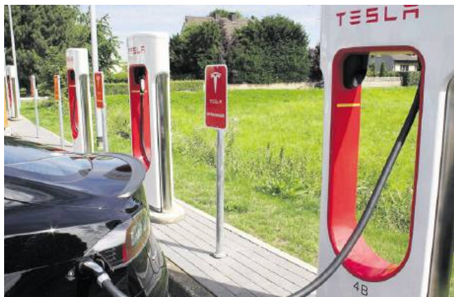
380 Kilometer Reichweite in einer halben Stunde: Laden eines Tesla Model S an der Schnellladestation am Kamener Kreuz. RN-FOTO MÜNCH
