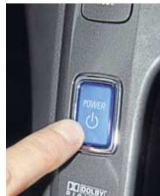
Ein Zündschloss sucht man beim Ampera vergebens. Gestartet wird er mit diesem Powerknopf. RN-Foto Woesmann
